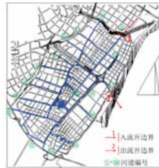
图 3 二维水动力模型开边界位置及河道编号
