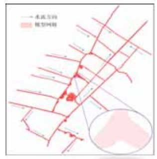
图2 水系二维水动力 模型计算网格
