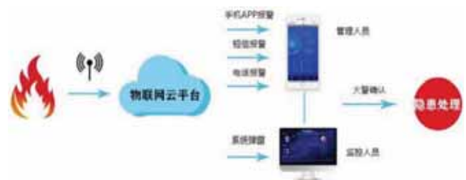
图3 智能监控系统火灾预警流程
